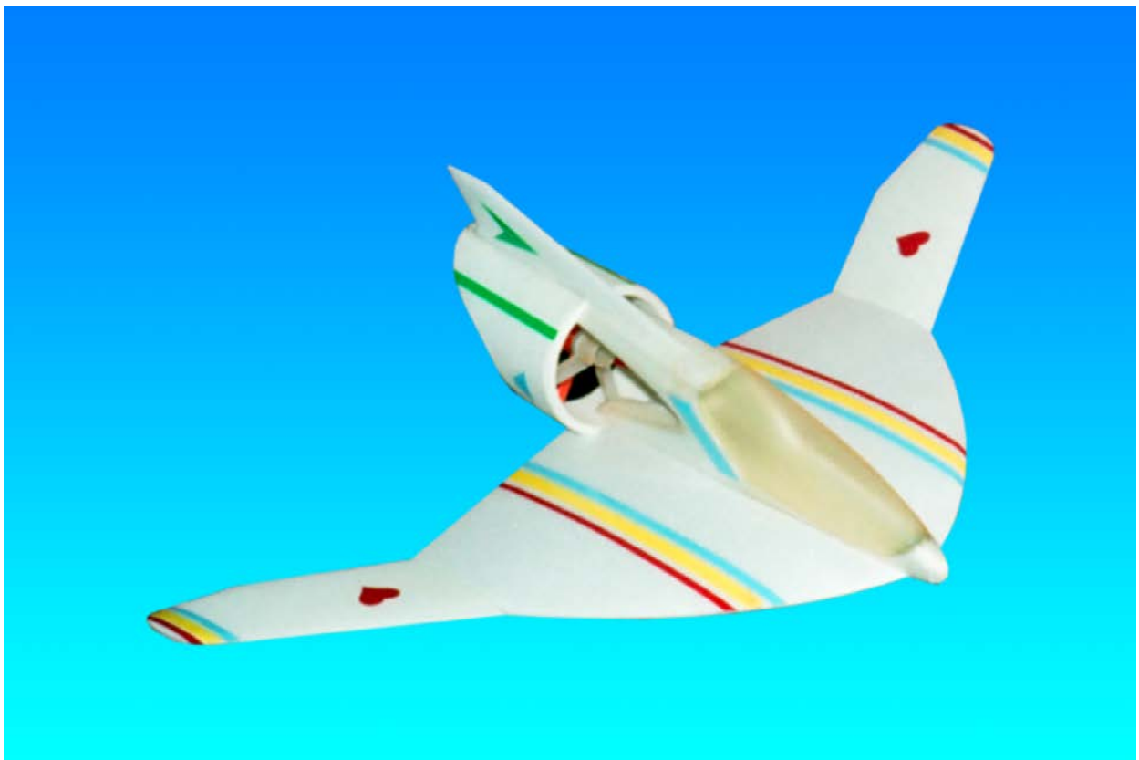
Одна из первых свободнолетающих экспериментальных моделей самолета для исследований эффективности Косого тягового кольца: 1) авторское свидетельство СССР №1804416 от 17.12.90г. 2) авторское свидетельство СССР №1819811 от 28.03.91г.
