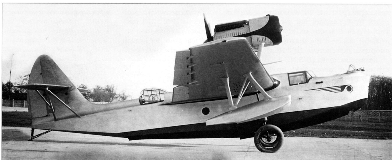
Гидросамолет ЦКБ МС-1 на колесном шасси. Двигатель ещё с нестандартным деревянным четырёхлопастным винтом. Аэродром завода №31, Таганрог, 1935 г. TsKBMS-1 seaplane on wheel gear. The engine is still supplied with the wooden four-wing propeller. The airfield of the plant №31, year 1935
