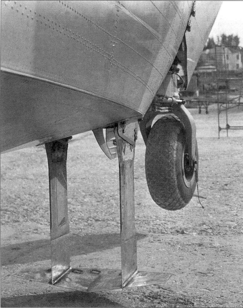
Подводное крыло в выпущенном положении. Water rudder in extended position.
