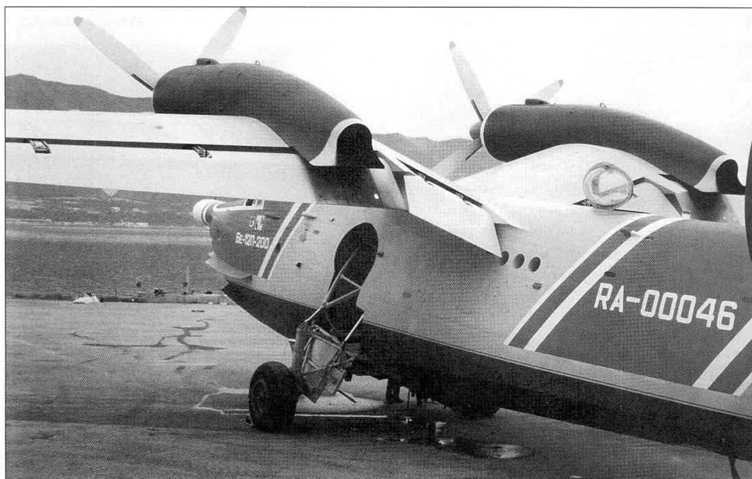
Летающая лаборатория Бе-12П-200. Механизация крыла выпущена. «Геленджик-96», сентябрь 1996 г.
