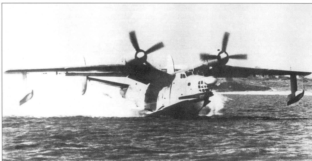
Особенностью самолетов-амфибий Бе-12 является возможность их базирования как на суше, так и на воде. The specifics of the Be-12 amphibian aircraft permit it to be based either on land or in the water.
