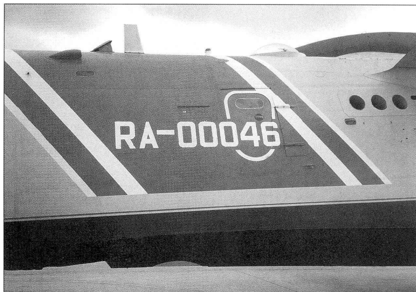
Летающая лаборатория Бе-12П-200. Хвостовая входная дверь и дренажное устройство емкостей для воды.
