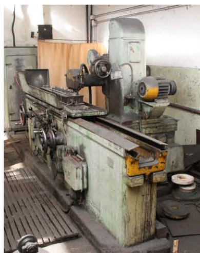
Цех 40: Плоскошлифовальный, модель Черчилль, инв. № 2761, зав. №. SS-8689 год. изг. 1940, подарок королевы Англии (табличка с него недавно пропала).
