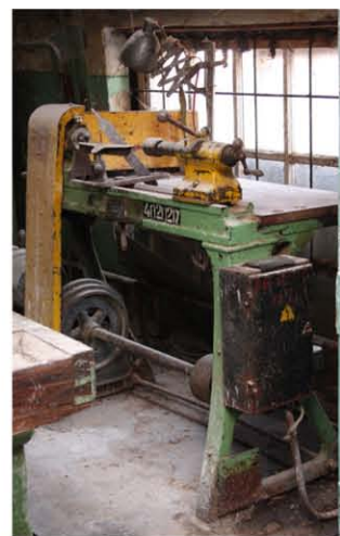
На столярном участке цеха 40, корпус 15: Токарный станок по дереву, модель Антунг, инв. № 5тд-1/3, год. изг. 1938.
