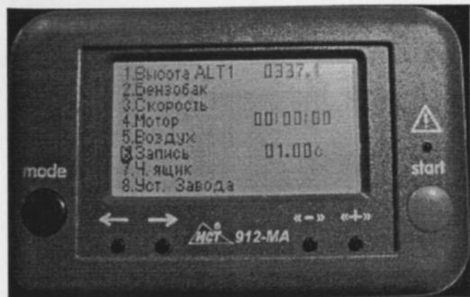
Режим НАСТРОЙКА ПРИБОРА – по нажатию кнопки MODE.
